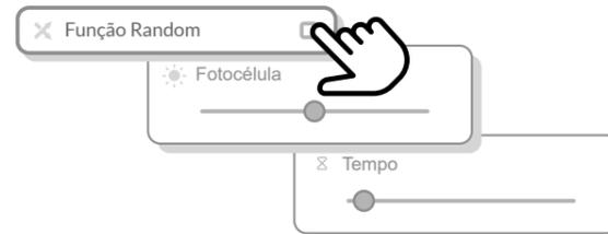
**Função Random** - simula a presença no ambiente, liga e desliga a lâmpada aleatoriamente na ausência de luz natural, variando entre 10 minutos até 3 horas e 40 minutos
